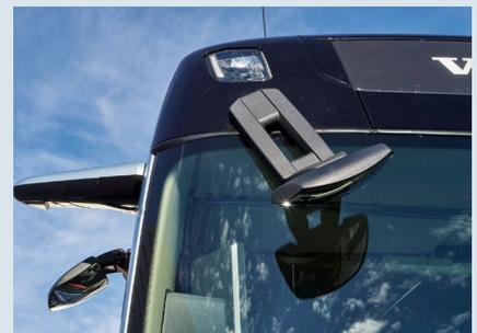
Der Frontspiegel ist konventionell ausgeführt und wirkt am windschnittigen Aero wie ein Fremdkörper
