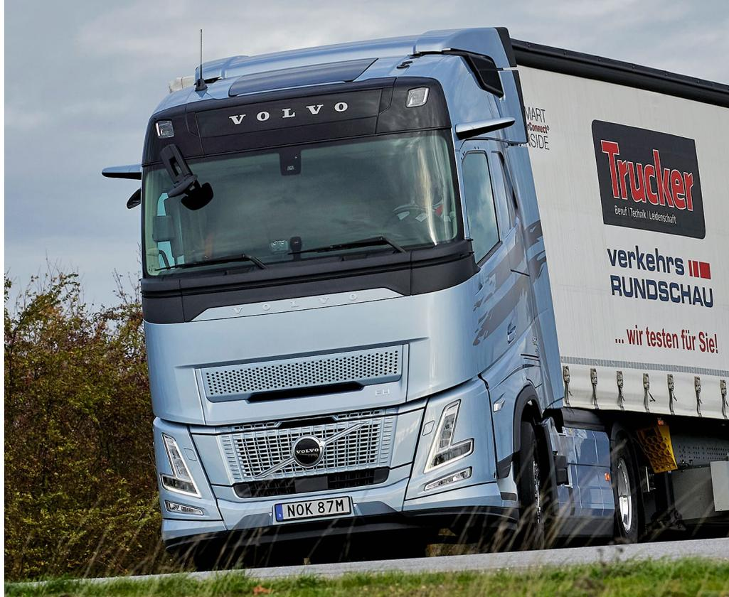
Die Aero-Front hat ein Mehrgewicht von 60 Kilogramm zum Normal-FH zur Folge
